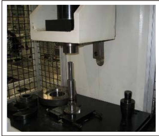
30. 压出输入轴四挡齿轮
