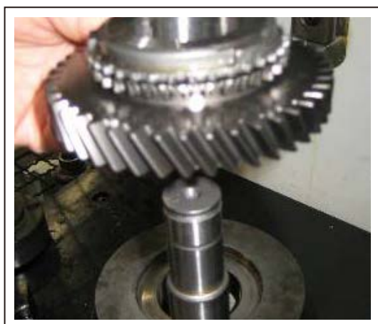
45. 拆下同步环总成、输出轴一档齿轮
