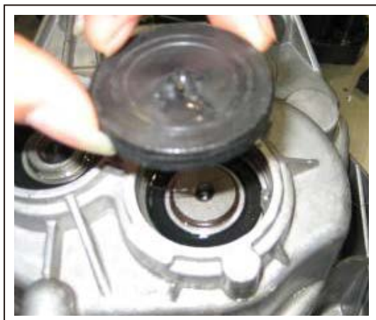
13. 拆下输出轴密封盖
