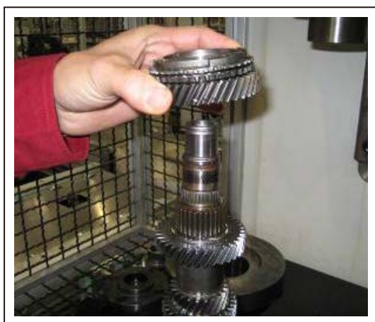
29. 拆下同步环、输入轴 5 挡齿轮组件和滚针轴承
