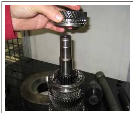
35. 拆下输出轴四挡齿轮组件、同步环和带衬套滚针轴承
