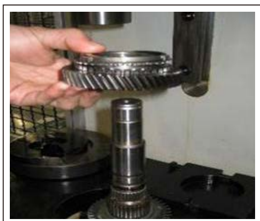
37. 拆下同步环总成和输出轴 2 挡齿轮组件
