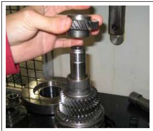
33. 压出输出轴六挡齿轮
