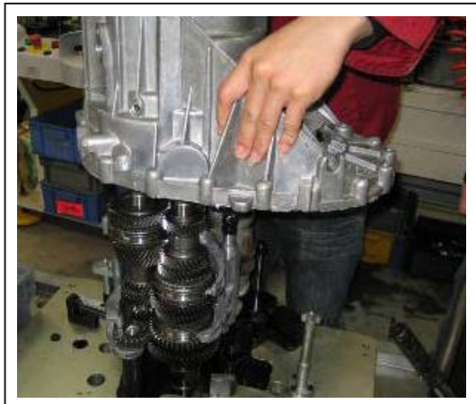
18. 拆下变速器壳体总成
