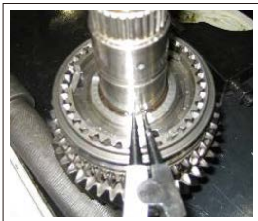
43. 用卡环钳拆下调整卡环
