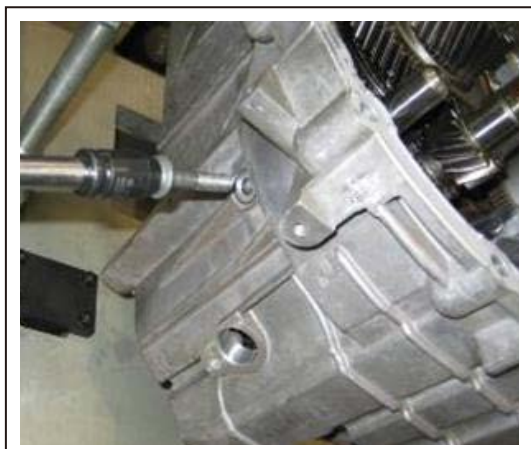
9. 拆下倒挡惰轮轴法兰面螺栓
