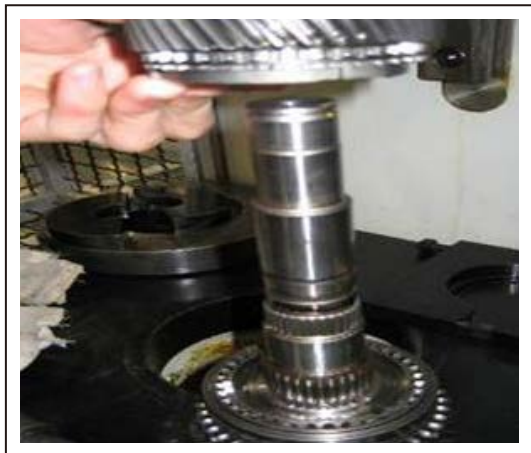
41. 拆下输出轴三挡齿轮组件和同步环总成
