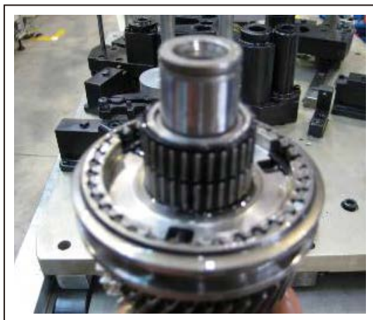
27. 拆下带衬套滚针轴承
