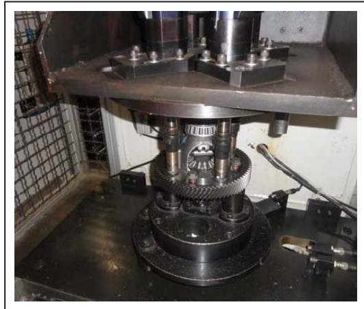
47. 拆下 8 颗法兰面螺栓
