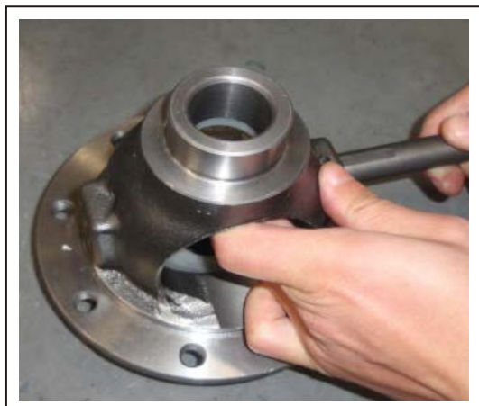
49. 拆下行星齿轮轴
