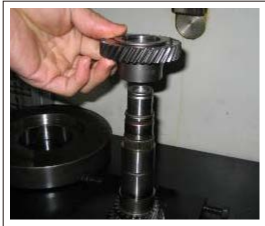
31. 取出输入轴四挡齿轮
