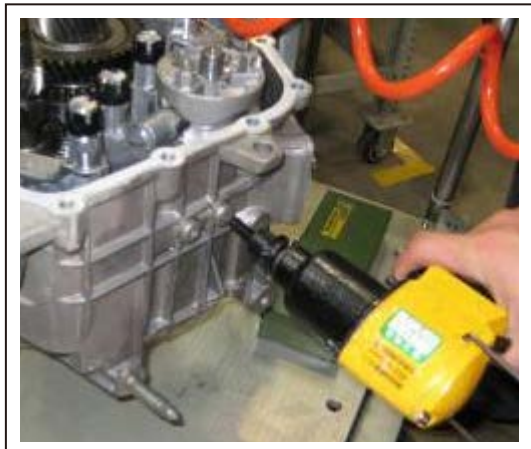
7. 拆下法兰面螺栓，使齿轮锁止装置总成脱离变速器壳凸槽
