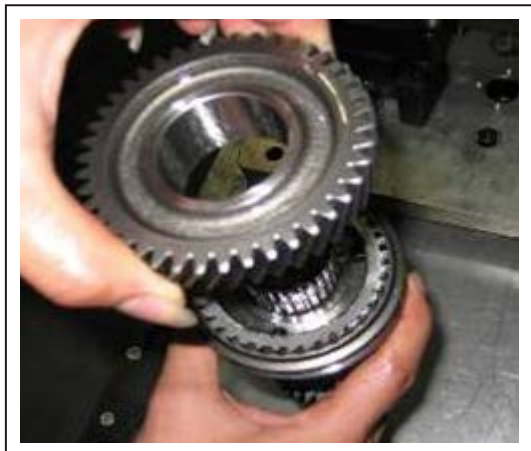
25. 拆下输入轴六挡齿轮组件
