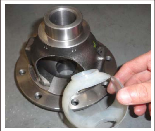
51. 拆下变速器球形衬垫
