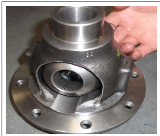
50. 取出半轴齿轮和行星齿轮
