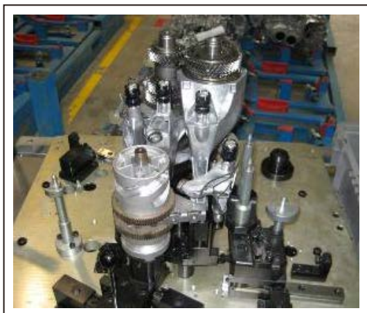
19. 移开换挡鼓总成
