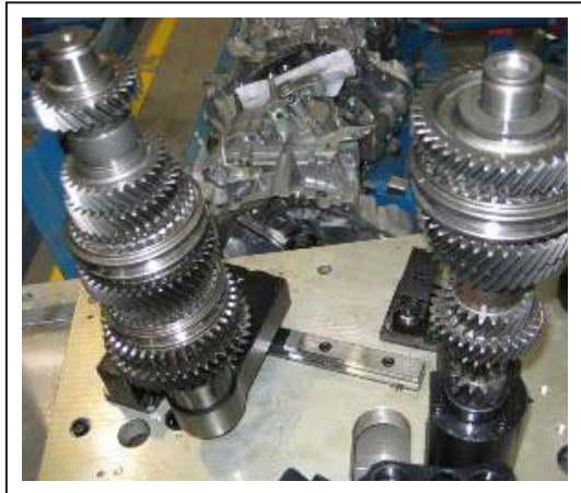
23. 分开输入轴总成和输出轴总成
