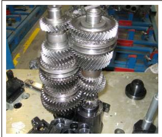
22. 拆下固定支架、倒挡惰齿轮总成和各换挡拨叉总成
