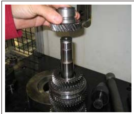
34. 压出输出轴五挡齿轮
