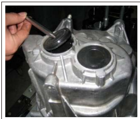
11. 拆下输入轴密封盖
